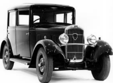
Peugeot 201 - Une nouvelle voiture sortie en 1929, avec, grande innovation en terme de sécurité... un frein sur chaque roue. Vitesse max : 80km/h
